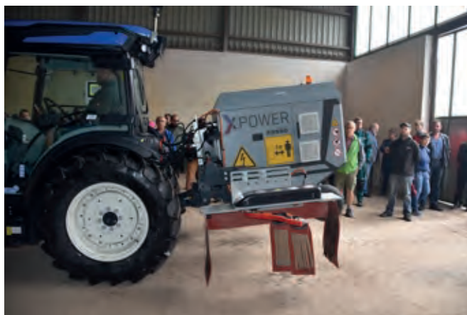
Equipment for destroying weeds by electric current Zařízení pro likvidaci plevelů elektrickým proudem
